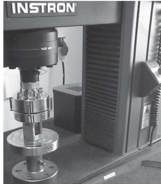
**Рис. 3.** Экспериментальное определение деформативности элементов планетарной передачи
