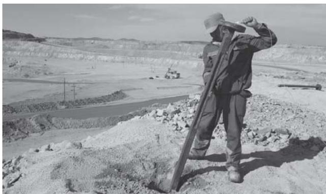
**Рис. 6. Монтаж опоры воздушного зазора во взрывной скважине на экспериментальном блоке**
