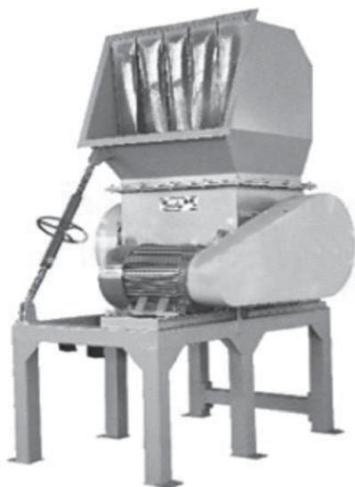
**Рис. 3.** Измельчитель синтетических отходов
